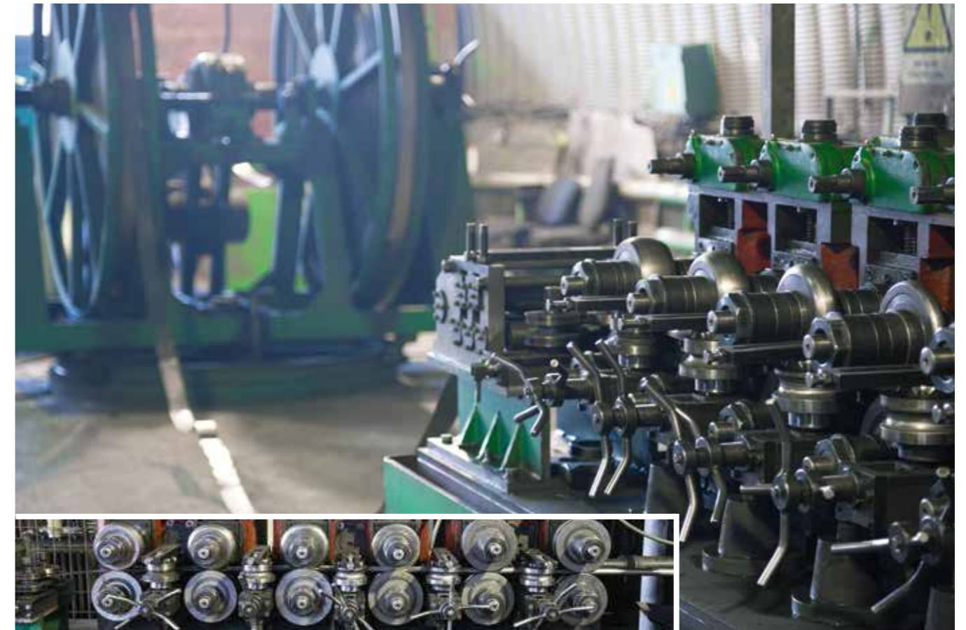
Трубопрокатный стан (линия производства сварного прямошовного металлического профиля)
