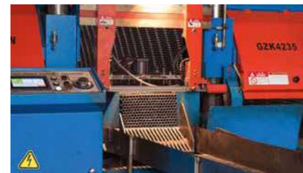
Автоматический ленточнопильный станок для пакетной резки металлического профиля
