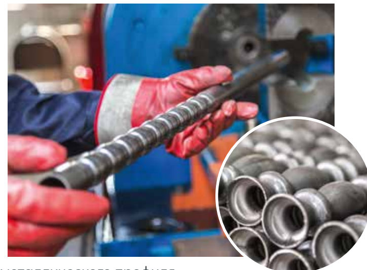
Станок для фигурной деформации тонкостенного металлического профиля
