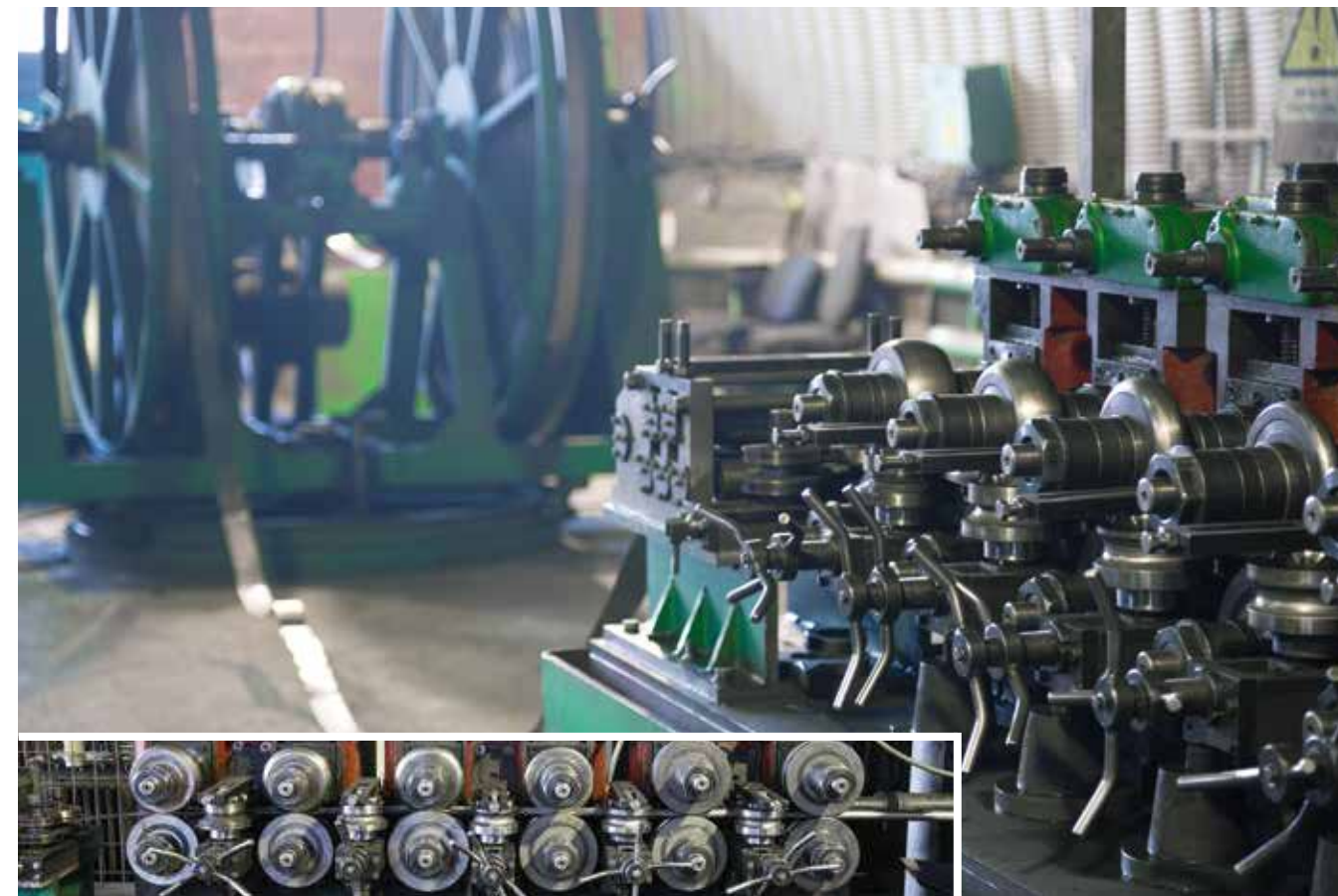
Трубопрокатный стан (линия производства сварного прямошовного металлического профиля)
